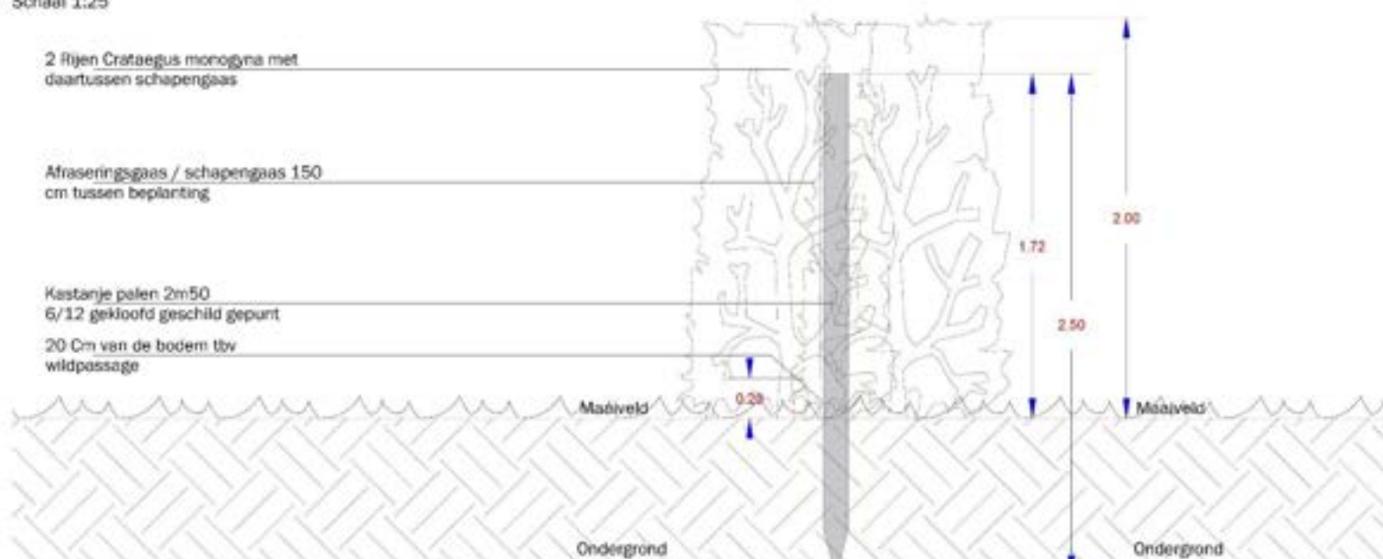
Principedetail gaashekwerken in een Meidoornhaag Schaal 1:25
